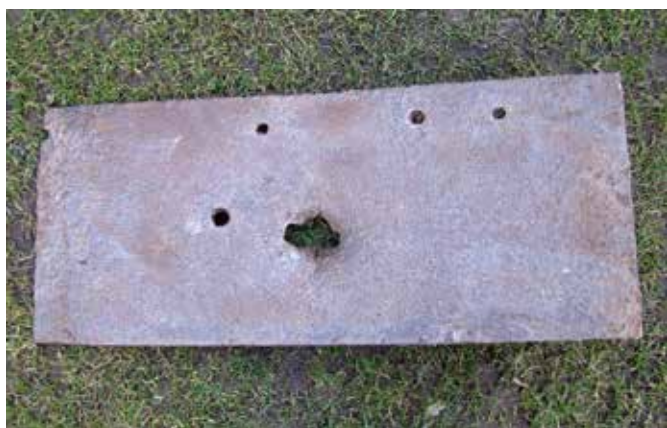
Płyta pancerna odnaleziona w 2008 r. w lesie kolanowskim. Grubość pancerza 15 mm i charakterystyczne otwory po nitach wskazują, że pochodzi ona z czołgu PzKpfw 38 (t) Panzerkampfwagen 38 (tschechische). Przystrelina pochodzi z polskiej armaty 37 mm ppanc. wz. 36
